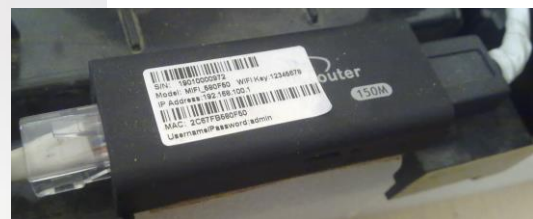
Obrázok 3: WiFi router mini použitý v našom projekte
