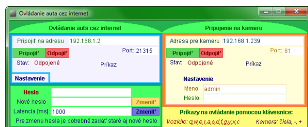
Obrázok 9: Java aplikácia na ovládanie vozidla cez UDP protokol a otáčanie kamery
